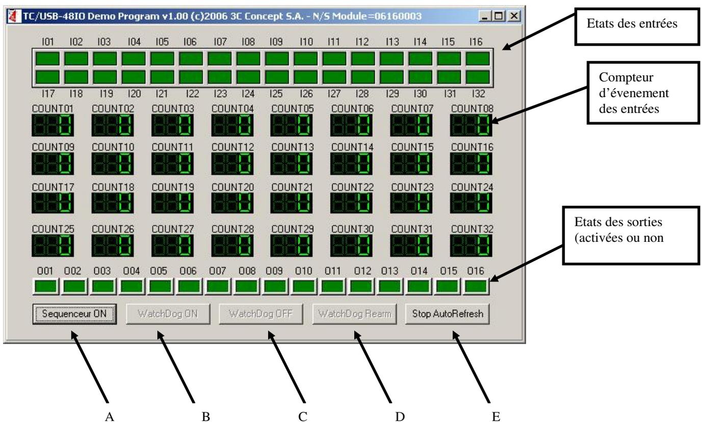
**NB :** Toutes les sorties sont pilotables manuellement en cliquant sur la zone verte de la sortie correspondante.
